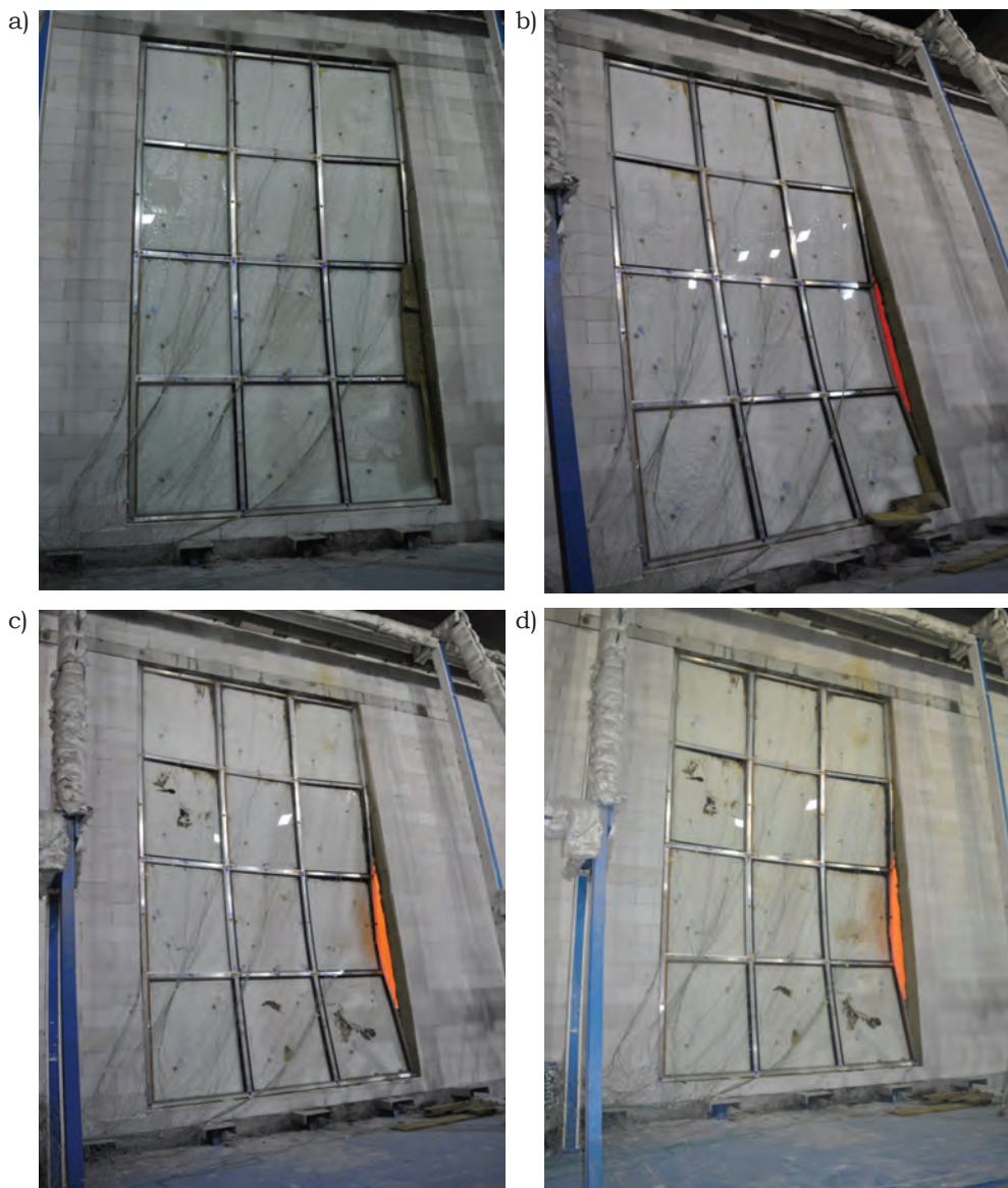
Rys. 39. Widok nienagrzewanej powierzchni elementu próbnego nr 7 a) w 16. minucie badania, b) w 31. minucie badania, c) w 46. minucie badania, d) w 61. minucie badania
