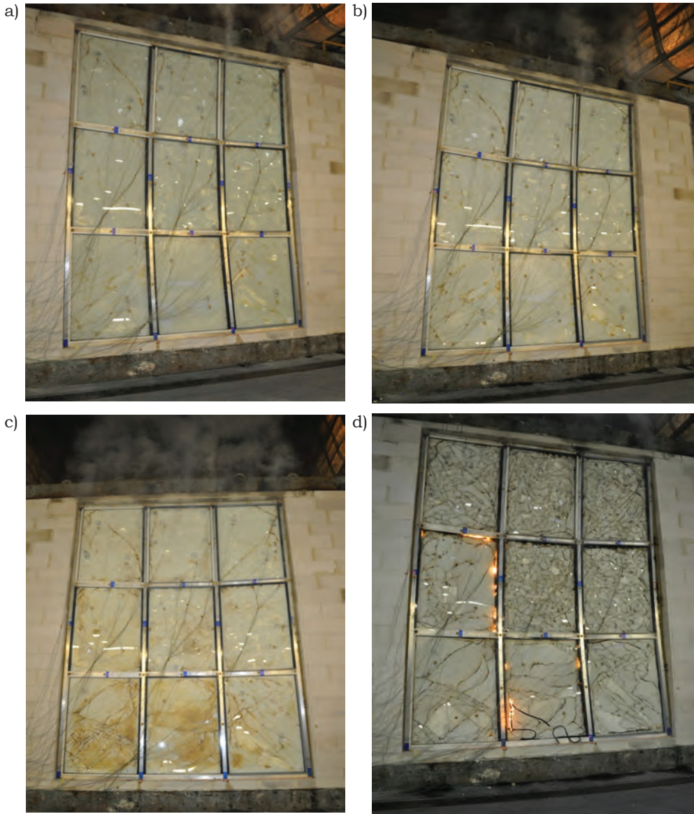
Rys. 40. Widok nienagrzewanej powierzchni elementu próbnego nr 8 a) w 16. minucie badania, b) w 22. minucie badania, c) w 31. minucie badania, d) w 51. minucie badania
