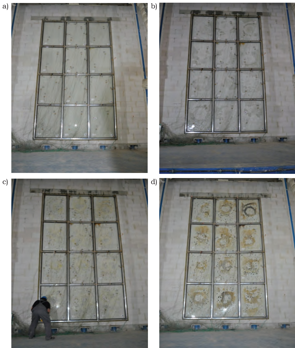
Rys. 38. Widok nienagrzewanej powierzchni elementu próbnego nr 6 a) w 16. minucie badania, b) w 31. minucie badania, c) w 46. minucie badania, d) w 61. minucie badania
