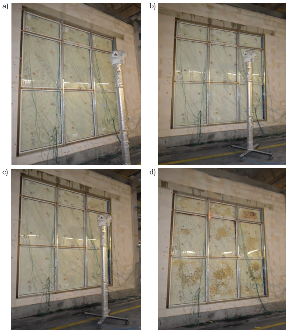
Rys. 35. Widok nienagrzewanej powierzchni elementu próbnego nr 3 a) w 16. minucie badania, b) w 31. minucie badania, c) w 46. minucie badania, d) w 61. minucie badania
