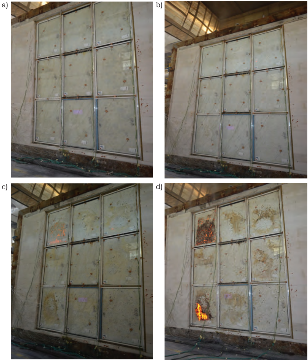
Rys. 36. Widok nienagrzewanej powierzchni elementu próbnego nr 4 a) w 16. minucie badania, b) w 31. minucie badania, c) w 48. minucie badania, d) w 61. minucie badania
