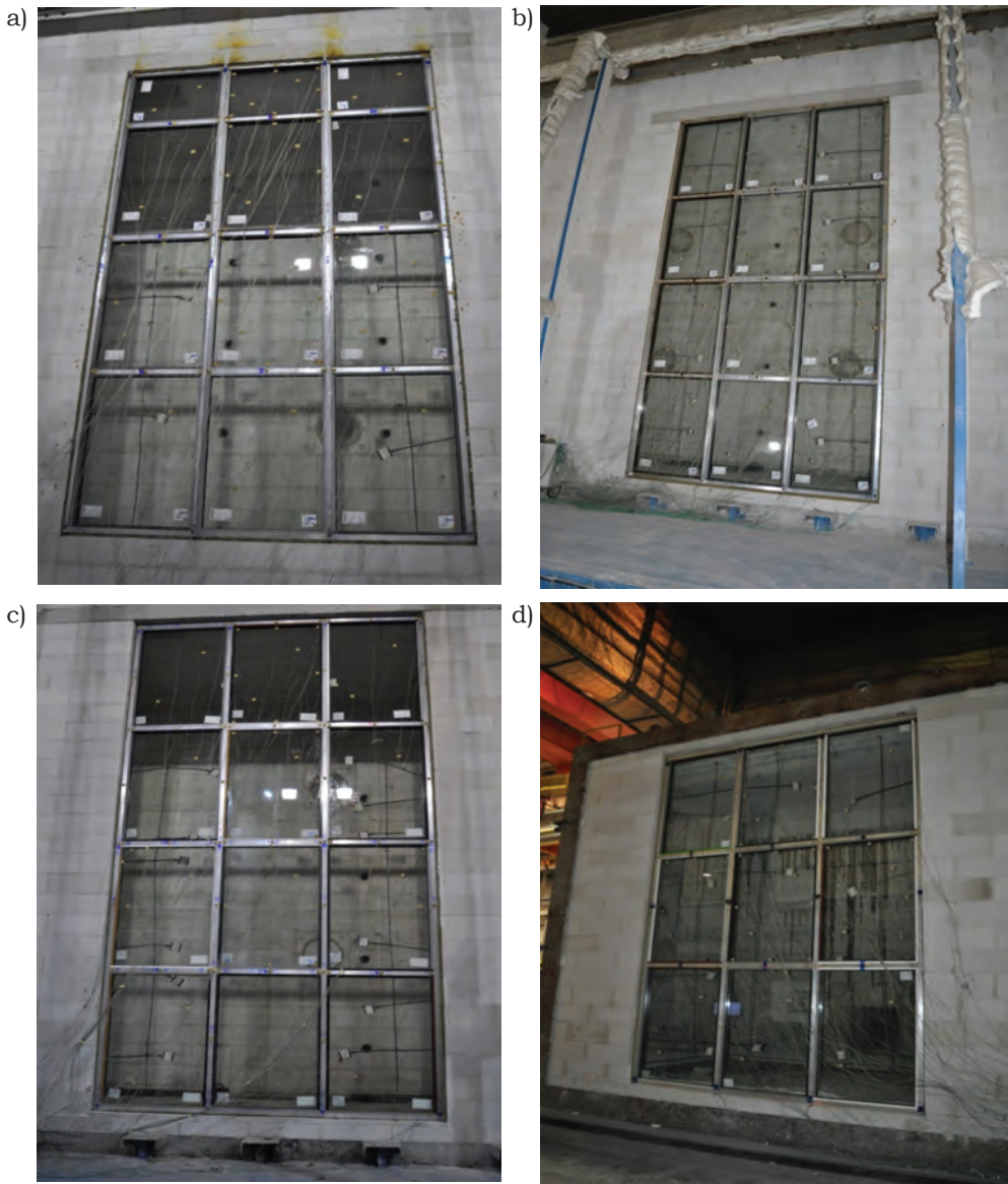
Rys. 26. Widok nienagrzewanej powierzchni elementów próbnych przed badaniem w zakresie odporności ogniowej
