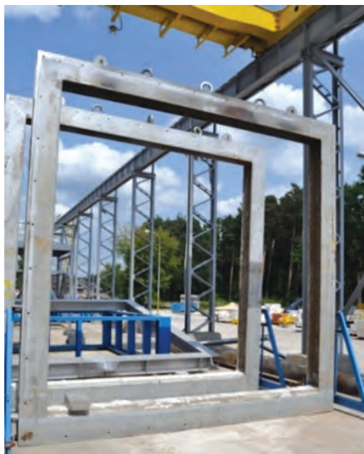
Rys. 11. Stalowe ramy do badań w zakresie odporności ogniowej [127]
