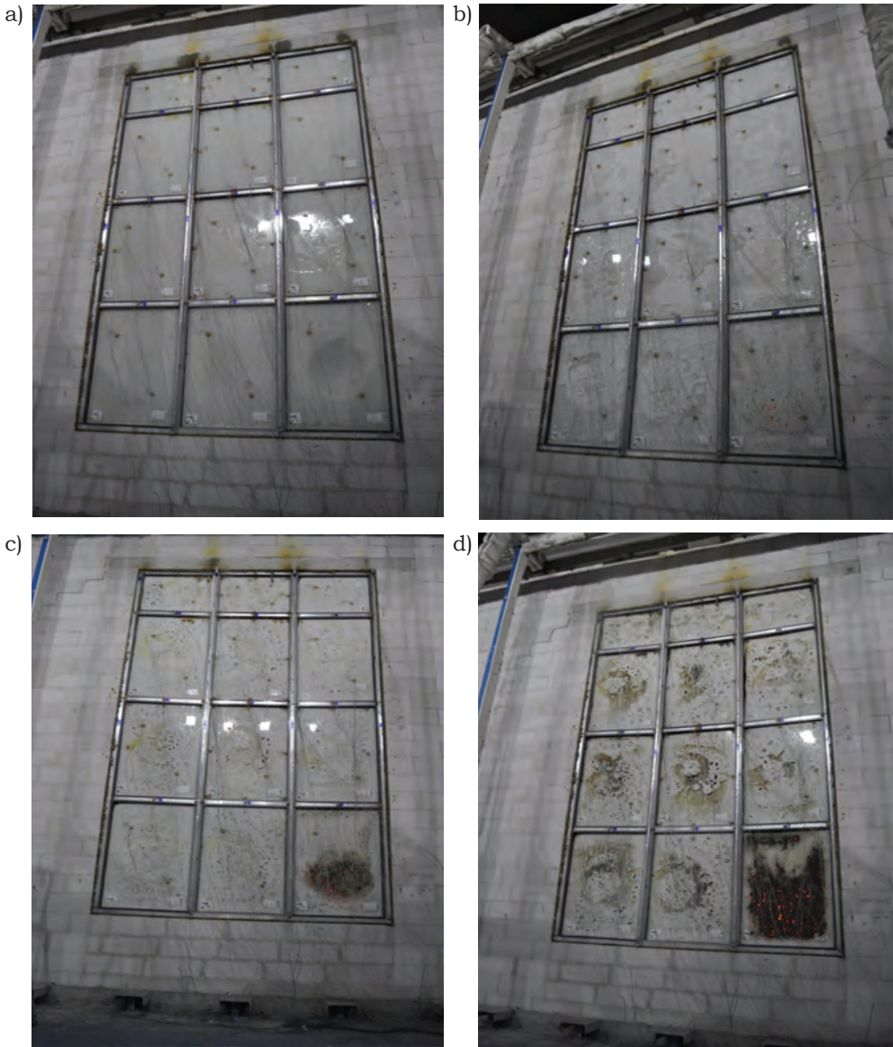
Rys. 37. Widok nienagrzewanej powierzchni elementu próbnego nr 5 a) w 16. minucie badania, b) w 31. minucie badania, c) w 46. minucie badania, d) w 62. minucie badania
