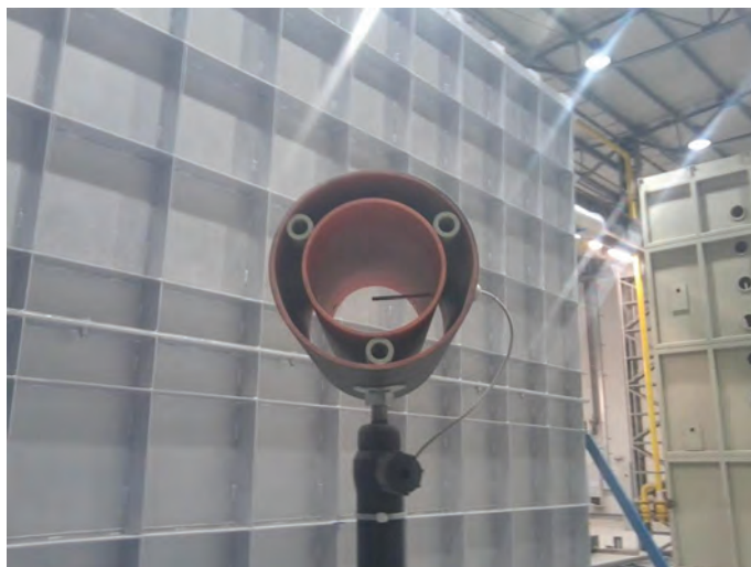
Rys. 15. Termoelement do pomiaru temperatury otoczenia [24]
