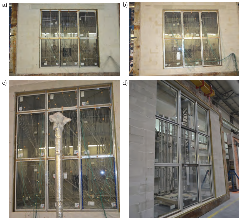
Rys. 25. Widok nienagrzewanej powierzchni elementów próbnych przed badaniem w zakresie odporności ogniowej
