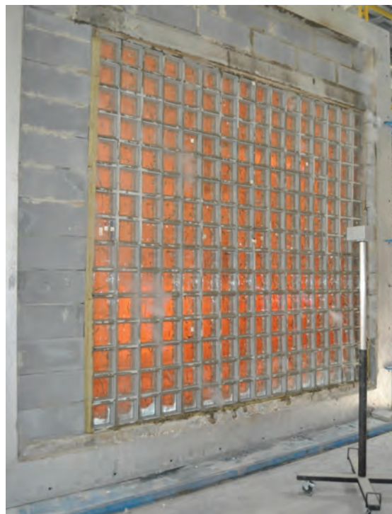
Rys. 17. Pomiar promieniowania prowadzony podczas badania odporności ogniowej ściany z pustaków szklanych [80]
